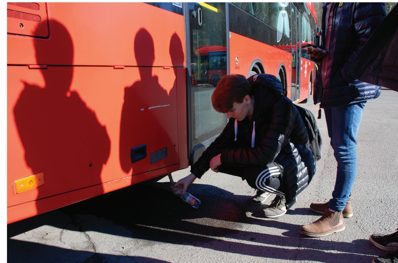
En elev tapper vann fra utslippet til hydrogenbussen. Kan dette vannet drikkes, tro? Foto: Naturfagsenteret
