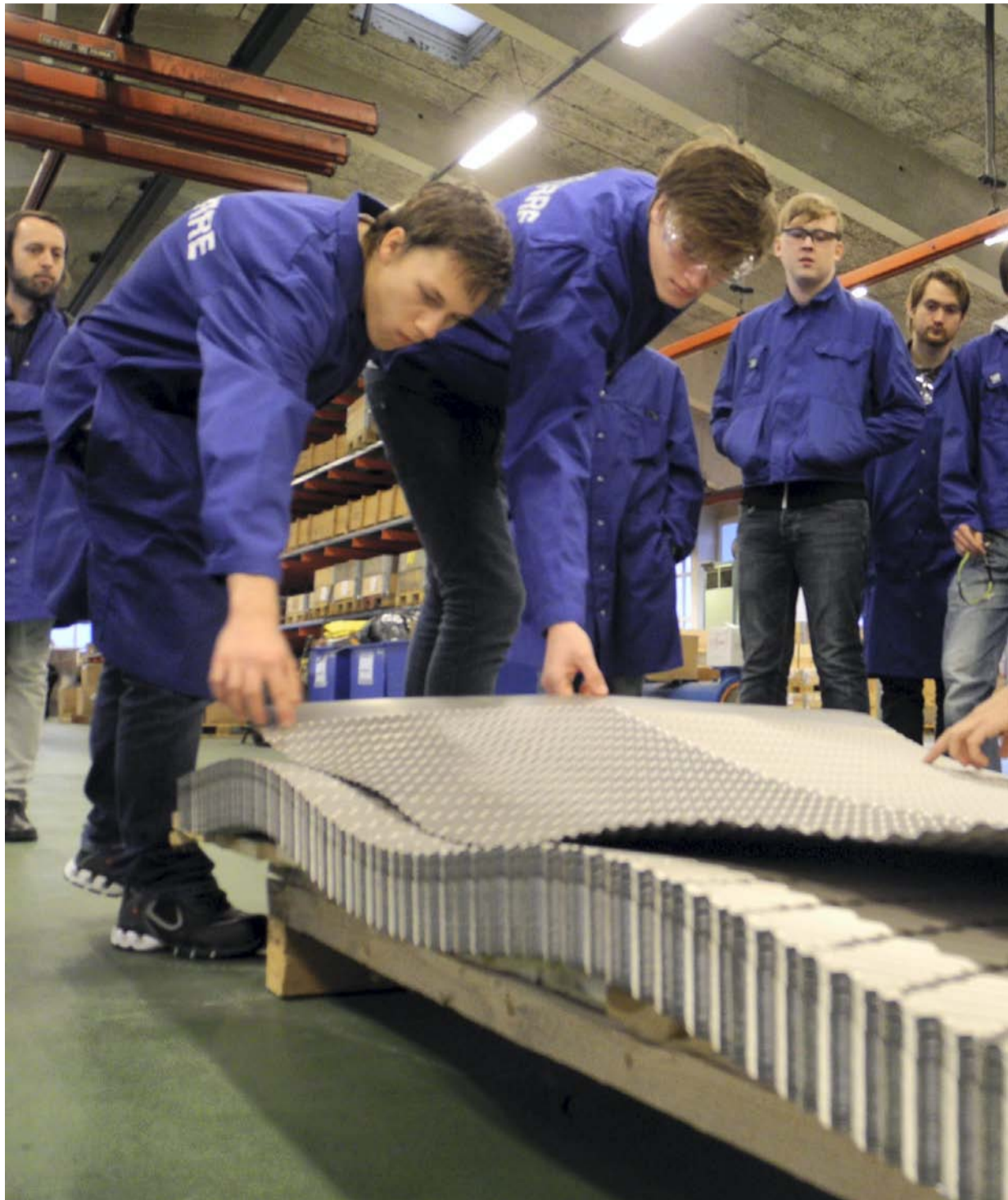
FAGDAG: Selger Per Kristian Urkedal (th) viser platina-plater som tåler det ekstreme miljøet av varmt sjøvann som skal kjøle ned motoren om bord i store skip.
